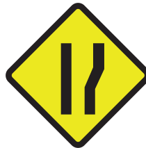
Peringatan Pelebaran Badan Jalan di Bagian Kanan
