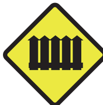
Peringatan Lebar Ruang Bebas (... m)
