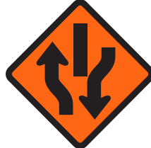
Peringatan Bagian Awal Rintangan yang Memisahkan Jalur
