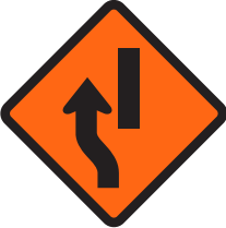
Peringatan Bagian Awal Rintangan pada Sisi Kanan Jalan
