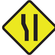
Peringatan Pelebaran Badan Jalan di Bagian Kiri
