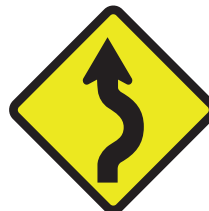
Peringatan Banyak Tikungan dengan Tikungan Pertama ke Kanan
