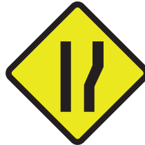
Peringatan Pelebaran Badan Jalan di Bagian Kanan
