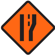
Peringatan Penambahan Lajur Kanan
