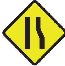
Peringatan Penyempitan Badan Jalan di Bagian Kanan
