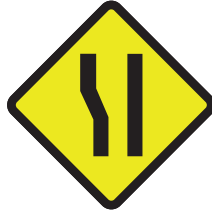
Peringatan Pelebaran Badan Jalan di Bagian Kiri
