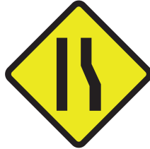
Peringatan Penyempitan Badan Jalan di Bagian Kanan
