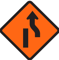
Peringatan Bagian Akhir Rintangan pada Sisi Kiri Jalan
