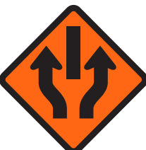
Peringatan Bagian Awal Rintangan yang Memisahkan Lajur
