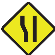
Peringatan Pelebaran Badan Jalan di Bagian Kiri
