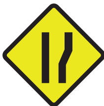
Peringatan Pelebaran Badan Jalan di Bagian Kanan
