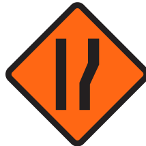
Peringatan Pelebaran Badan Jalan di Bagian Kanan
