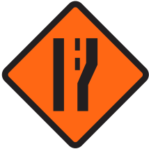
Peringatan Penambahan Lajur Kanan
