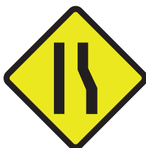
Peringatan Penyempitan Badan Jalan di Bagian Kanan
