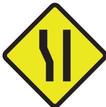
Peringatan Pelebaran Badan Jalan di Bagian Kiri
