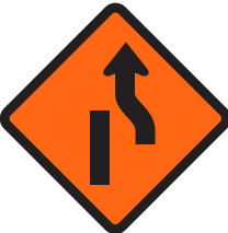
Peringatan Bagian Akhir Rintangan pada Sisi Kiri Jalan
