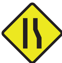
Peringatan Penyempitan Badan Jalan di Bagian Kanan
