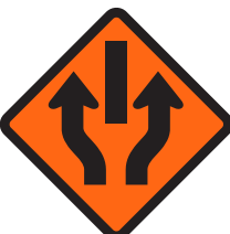
Peringatan Bagian Awal Rintangan yang Memisahkan Lajur
