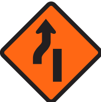
Peringatan Bagian Akhir Rintangan pada Sisi Kanan Jalan
