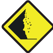
Peringatan Bagian Tepi Jalan Sebelah Kiri yang Rawan Runtuh
