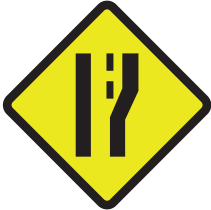
Peringatan Penambahan Lajur Kanan
