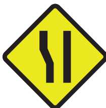
Peringatan Pelebaran Badan Jalan di Bagian Kiri
