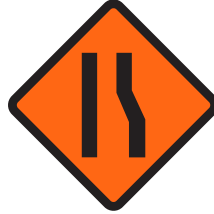
Peringatan Penyempitan Badan Jalan di Bagian Kanan
