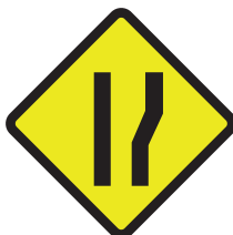
Peringatan Pelebaran Badan Jalan di Bagian Kanan
